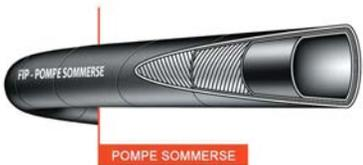
**Tubo sottile per mandata acqua industriale ed altri fluidi non corrosivi. Sottostrato nero liscio in gomma sintetica, inserzioni tessili ad alta tenacità, copertura in gomma sintetica resistente alle intemperie, all'ozono ed all'abrasione. Superficie esterna nera liscia ad impressione di tela. Temperatura di esercizio: -35°C +70°C. Altre dimensioni lunghezze e colori sono realizzabili su richiesta.**
