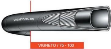
**Tubo per mandata di acqua industriale, anticrittogamici, diserbanti ecc. Sottostrato nero liscio in gomma sintetica, inserzioni tessili ad alta tenacità, copertura in gomma sintetica resistente alle intemperie, all'ozono ed all'abrasione. Superficie esterna nera liscia ad impressione di tela. Temperatura di esercizio: -25°C +70°C. Altre dimensioni lunghezze e colori sono realizzabili su richiesta.**
