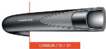
Tubo long length per mandata di benzina, nafta e gasolio, esclusa benzina verde. Sottostrato nero liscio in gomma nitrilica, con ottime caratteristiche meccaniche, rete di fili poliestere ad alta tenacità, copertura in gomma sintetica resistente ai prodotti petroliferi, all'abrasione ed all'invecchiamento. Superficie esterna nera liscia. Temperatura di esercizio: -20°C +80°C. Antistatico. Altre dimensioni, lunghezze e colori sono realizzabili su richiesta.
