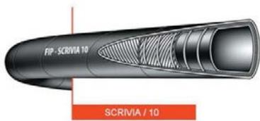
Tubo per mandata ed aspirazione di acqua industriale ed altri fluidi non corrosivi. Sottostrato nero liscio in gomma sintetica, inserzioni tessili ad alta tenacità, spirale acciaio incorporata, copertura in gomma sintetica resistente alle intemperie, all'ozono ed all'abrasione. Superficie esterna nera liscia ad impressione di tela. Temperatura di esercizio: -35°C +70°C. Altre dimensioni lunghezze e colori sono realizzabili su richiesta.
