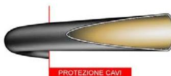
Tubo in gomma e tela usato per il rivestimento e protezione dei cavi, ideale per il rivestimento delle torce di saldatura. Sottostrato liscio in gomma sintetica con tessuto visibile, copertura in gomma sintetica, resistente alle intemperie, all'abrasione ed all'ozono. Superficie esterna colore nero liscia ad impressione di tela. Temperatura di esercizio: -30°C +85°C. Altre dimensioni, colori e pressioni sono realizzabili su richiesta.
