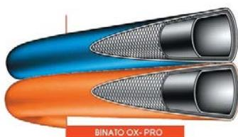
Tubo long length termosaldato a normativa per saldatura autogena, idoneo alla mandata di ossigeno ed propano. Sottostrato nero liscio in gomma sintetica, rete di fili sintetici ad alta tenacità, copertura in gomma sintetica resistente alle intemperie ed all'abrasione. Superficie esterna colore blu (per ossigeno) arancione (per propano) liscia. Temperatura di esercizio: -20°C +70°C. NB: BEST = coestruso made in CE
