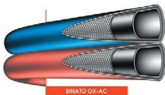
Tubo long length termosaldato a normativa per saldatura autogena, idoneo alla mandata di ossigeno ed acetilene. Sottostrato nero liscio in gomma sintetica, rete di fili sintetici ad alta tenacità, copertura in gomma sintetica resistente alle intemperie ed all'abrasione. Superficie esterna colore blu (per ossigeno) rosso (per acetilene) liscia. Temperatura di esercizio: -20°C +80°C. NB: BEST = coestruso made in CE
