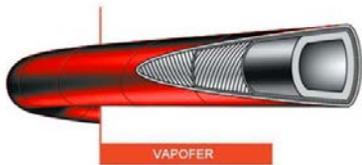
Tubo per mandata di vapore saturo. Sottostrato nero liscio in gomma sintetica resistente alle alte temperature, inserzioni di fili d'acciaio, copertura in gomma sintetica resistente alle alte temperature, alle intemperie, all'ozono ed all'abrasione. Superficie esterna nera oppure rossa, liscia ad impressione di tela. Temperatura di esercizio: -40°C +210°C. Altre dimensioni, lunghezze e colori sono realizzabili su richiesta.
