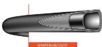
Tubo long length a normativa per saldatura autogena, idoneo alla mandata di gas inerti, ad esempio azoto, argon, anidride carbonica e aria compressa. Sottostrato nero liscio in gomma sintetica, rete di fili sintetici ad alta tenacità, copertura in gomma sintetica resistente alle intemperie ed all'abrasione. Superficie esterna colore nero liscia. Temperatura di esercizio: -30°C +70°C. Diametro interno da 4 a 10 mm. Altre lunghezze e pressioni disponibili su richiesta. Made in CE.
