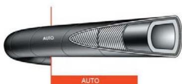
**Tubo per mandata di acqua calda e fluidi antigelo nei circuiti di raffreddamento dei motori. Sottostrato nero liscio in gomma sintetica resistente alle alte temperature, inserzioni tessili ad alta tenacità, copertura in gomma sintetica resistente alle alte temperature, alle intemperie, all'ozono ed all'abrasione. Superficie esterna nera liscia ad impressione di tela. Temperatura di esercizio: -35°C +120°C. Altre dimensioni, lunghezze e colori sono realizzabili su richiesta.**
