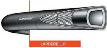
Tubo per mandata di vapore. Sottostrato nero liscio in gomma sintetica resistente al vapore, inserzioni tessili ad alta tenacità, copertura in gomma sintetica resistente alle alte temperature, alle intemperie, all'ozono ed all'abrasione. Superficie esterna nera liscia ad impressione di tela. Temperatura di esercizio: -40°C +164°C. Altre dimensioni, lunghezze e colori sono realizzabili su richiesta.
