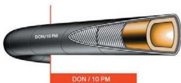
Tubo per mandata di materiali inerti abrasivi, sabbia, ghiaia, cemento ecc. Sottostrato liscio in gomma naturale nocciola ad elevata resistenza all'abrasione, inserzioni tessili ad alta tenacità, cavetto di rame, copertura in gomma sintetica resistente alle intemperie, all'ozono ed all'abrasione. Superficie esterna nera liscia ad impressione di tela. Temperatura di esercizio: -25°C +70°C. Realizzabili altre dimensioni e colori.
