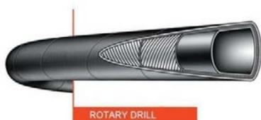
**Tubo per mandata di aria compressa, resistente alle tracce di olio nebulizzato. Sottostrato nero liscio in gomma sintetica, inserzioni tessili ad alta tenacità, copertura in gomma sintetica resistente alle intemperie, all'ozono ed all'abrasione. Superficie esterna nera liscia ad impressione di tela. Temperatura di esercizio: -30°C +70°C. Altre dimensioni, lunghezze e colori sono realizzabili su richiesta.**
