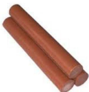
Isolante stratificato a base di cotone a tessitura fine (fili 24x24 + 2) e resina fenolica, utilizzato per pezzi lavorati e tranciati. Per uso meccanico; idoneo per applicazioni elettriche a bassa tensione.
