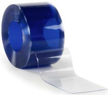
Grazie all'aggiunta di plastificanti nella formulazione base si ottiene il PVC flessibile che viene prodotto con il sistema della calandratura da cui si ottengono mantelli destinati alla produzione di porte industriali, di rivestimenti, di fustellati tecnici, ecc. Versione trasparente azzurrato e con maggior stabilità all'ambiente esterno.
