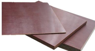
Isolante stratificato a base di cellulosa e resina fenolica, utilizzato per pezzi lavorati e tranciati. Ha buone caratteristiche dielettriche anche in ambiente umido, discrete proprietà meccaniche e ottima tranciabilità anche a freddo.
