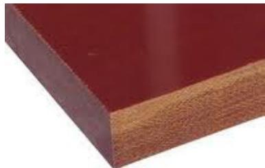
Isolante stratificato a base di cotone a tessitura fine (fili 24x24 + 2) e resina fenolica, utilizzato per pezzi lavorati e tranciati. Per uso specificatamente meccanico; idoneo per applicazioni elettriche a bassa tensione. Impiegato in ingranaggi, ingranaggi a modulo piccolo, camme e cuscinetti.
